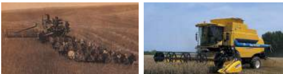
À gauche : moissonneuse actionnée par un attelage de 33 chevaux en 1902 dans l'État de Washington, États-Unis. À droite : moissonneuse batteuse moderne de taille moyenne, développant une puissance de 300 chevaux-vapeurs. Crédits : Robert N., domaine public ; PRA, CC BY-SA, Wikimedia Commons.
